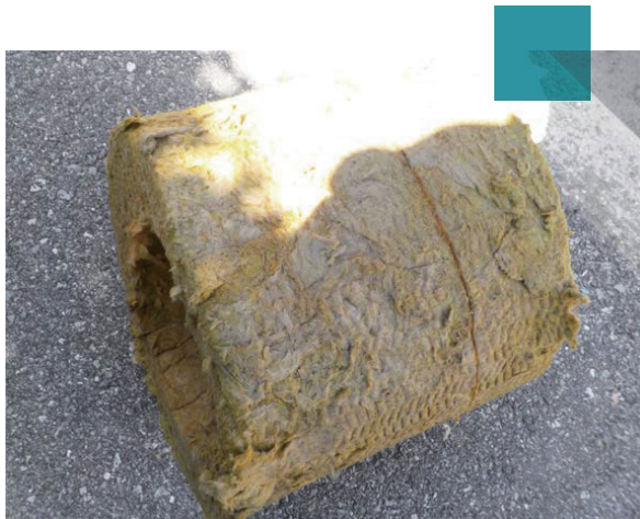
120℃から140℃で3年間使用後のROCKWOOL WR-Techの断熱材
