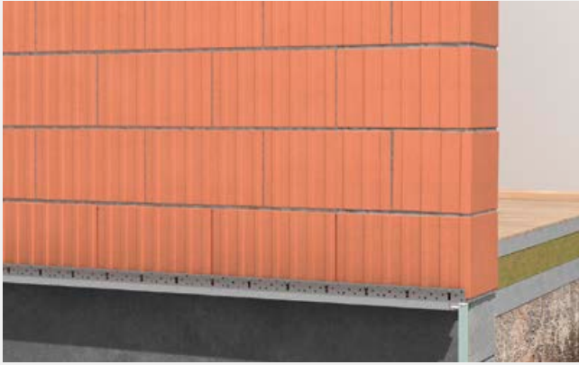
Mocowanie listwy cokołowej.
