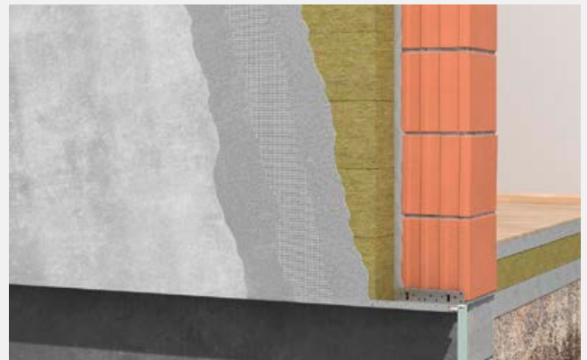
Malowanie podkładem tynkarskim w kolorze tynku.
