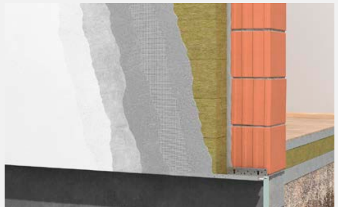
Malowanie białych tynków mineralnych gruntem pod farbę elewacyjną.
