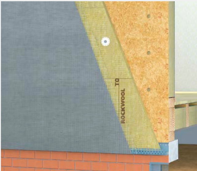
Nałożenie zaprawy zbrojącej i wtopienie siatki zbrojącej.
