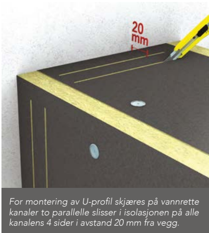
På vannrette kanaler monteres U-profiler i slissene i isolasjonen og festes til kanalen med 2 stk 70 mm selvboende skruer i hver.
