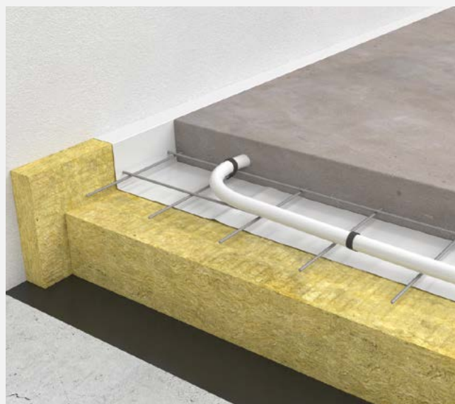
Ułożenie podkładu cementowego.
